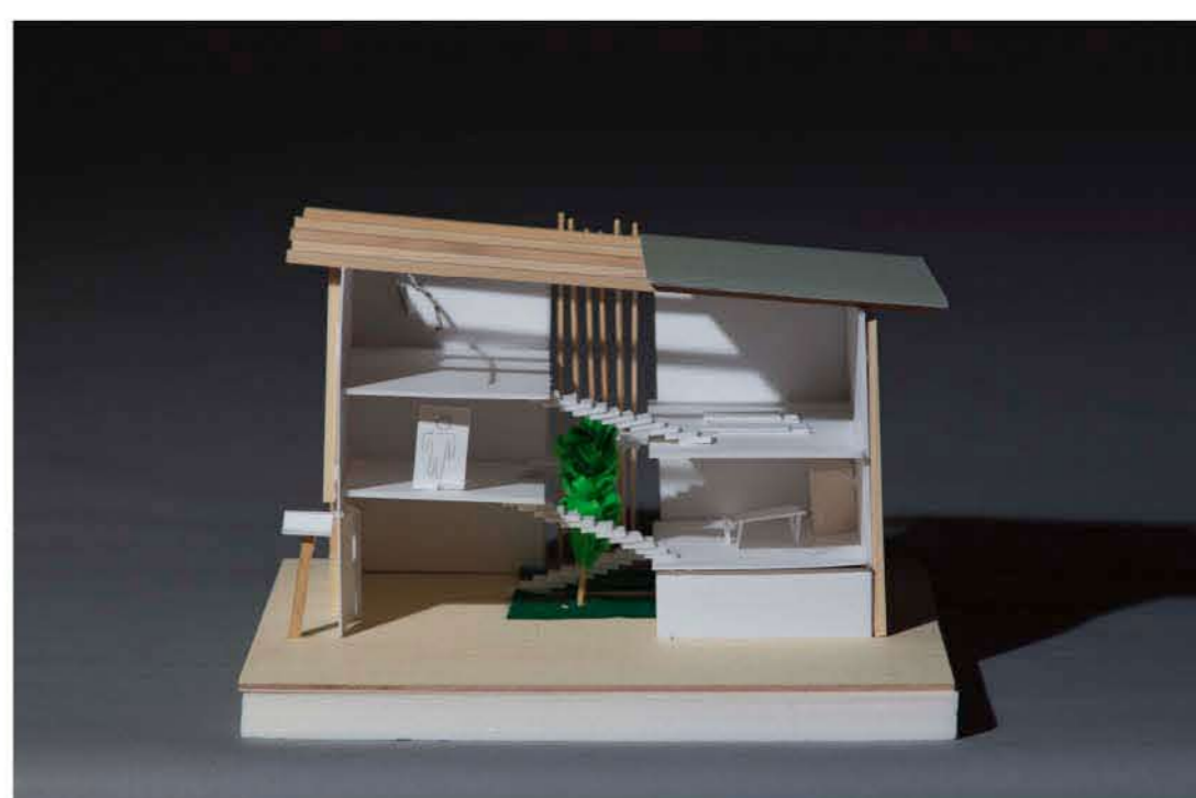
まちなかの狭小地でも広く感じる、スキップフロアの町家。
